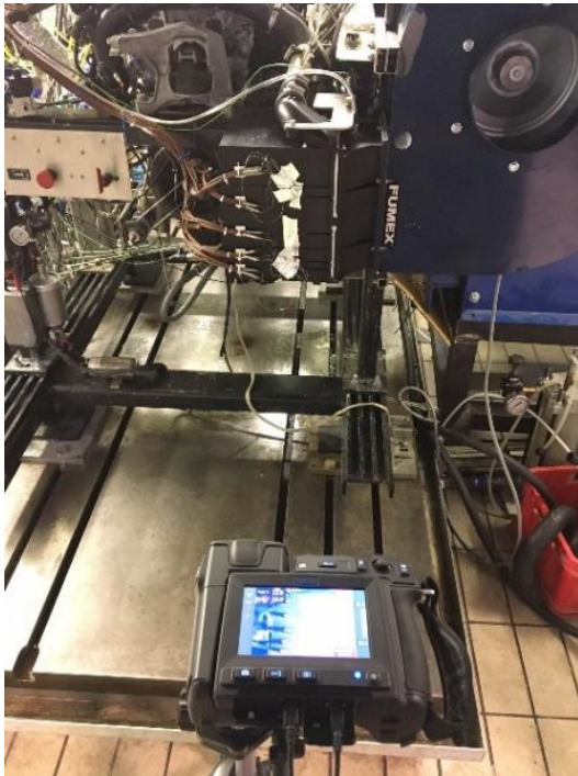
Figure 56 : Vue du RAS dans son carénage avec la caméra thermique
