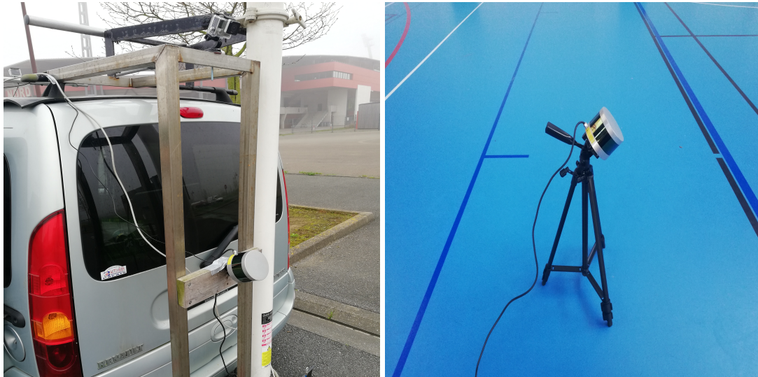
(a) VLP-16 LiDAR monté sur un véhicule (b) LiDAR VLP-16 monté sur un support fixe
