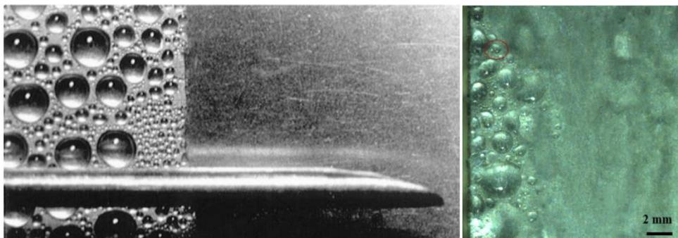
Figure 1.1 : A gauche : condensation en gouttes et condensation en film (Incropera *et al.*, 2007). Le tube en bas de l'image est indiqué pour l'échelle et a un diamètre de 1 mm. A droite : écoulement mixte (film/gouttes) (Parin *et al.*, 2018).
