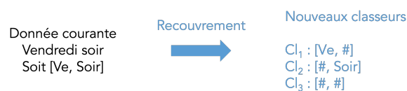
FIGURE 2.6 – Illustration du processus de recouvrement fabriquant de nouveaux classeurs correspondant à la donnée d'apprentissage courante.
