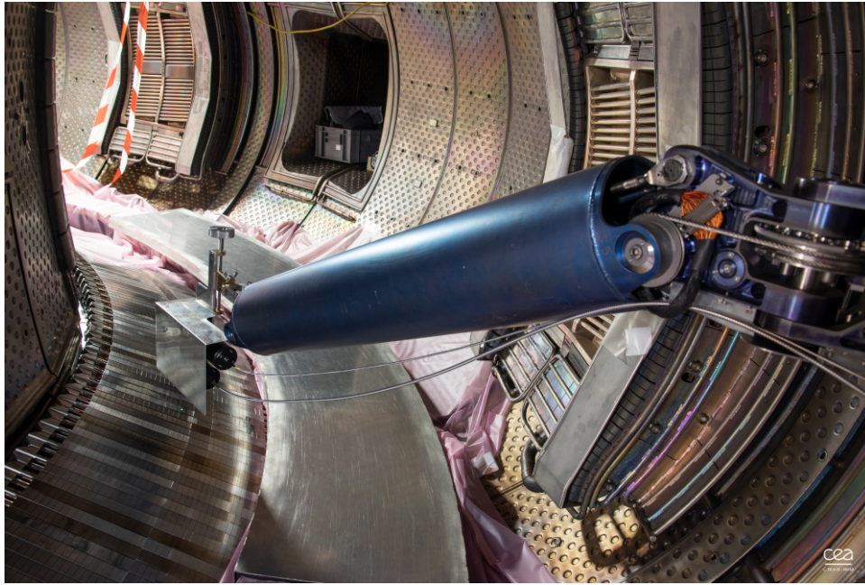
FIGURE III.4.10 – Photographie du dispositif fibré à l’extrémité du bras AIA au sein de WEST. La chambre torique est caractérisée par un grand rayon de 2,5 m pour une hauteur de 1,5 m.
