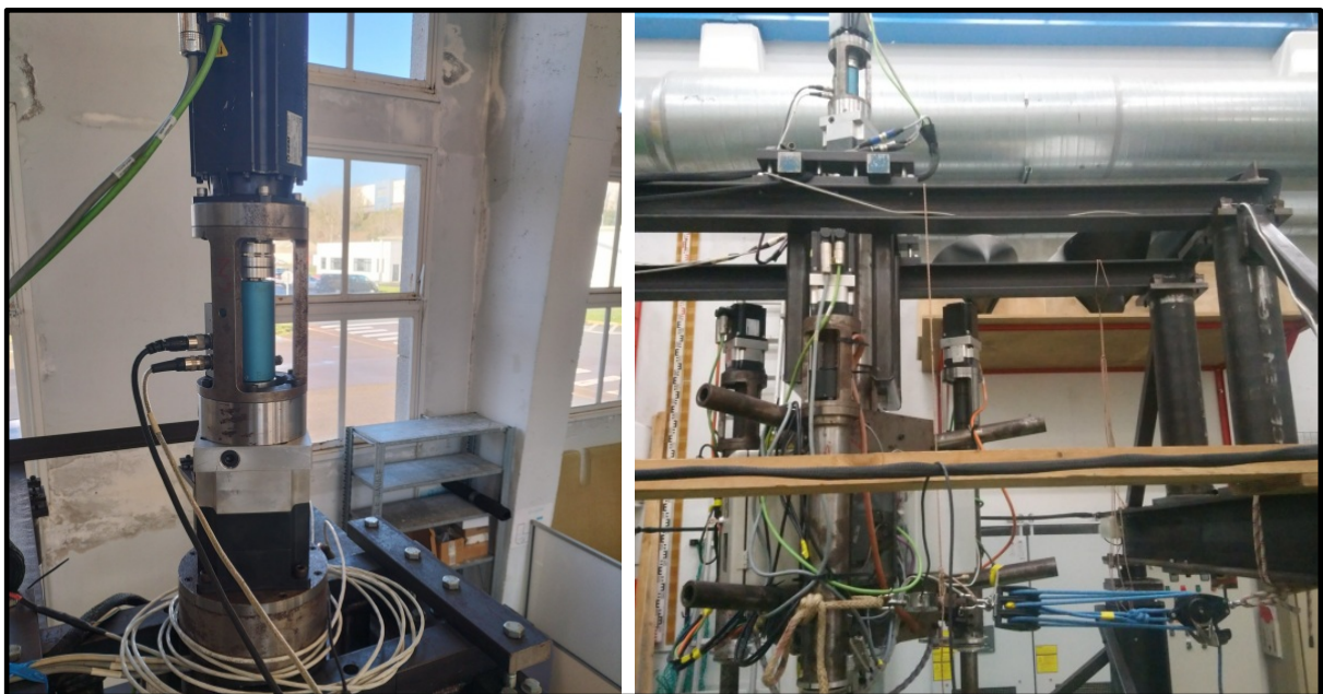
FIGURE 4.36 – A gauche, installation du couplemètre (en bleu clair) entre le moteur principal et le réducteur. A droite, montage du système d'étalonnage du couplemètre avec un palan multi-brins repris sur le support fixe associé à un capteur d'effort appliquant une tension sur un des bras du support triangulaire.
