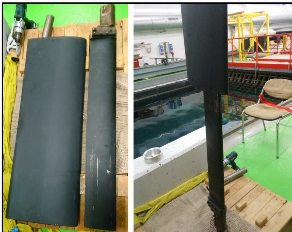
FIGURE 2.5 – Photos d'une pale et de sa coque en fibre de verre permettant d'augmenter la taille de la corde.
