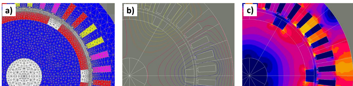
Figure II.6 - Maillage, lignes de champs magnétique et mapping de l'induction magnétique d'un moteur synchrone à aimants permanents réalisés sous Flux2D
