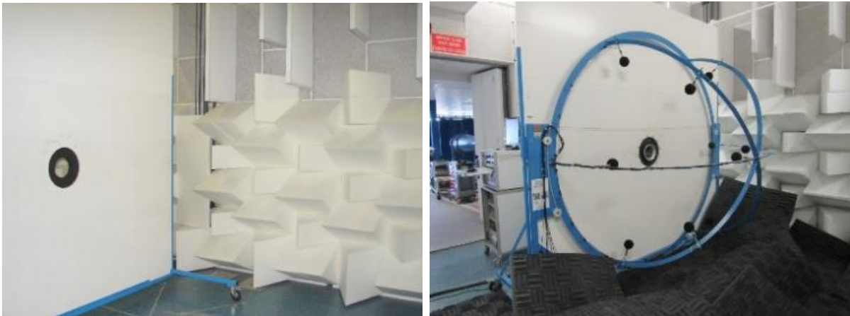
Figure I.5 – Salle anéchoïque de tests vibro-acoustiques et ventilateur placé sur le banc d'essai pour mesure du bruit à son aspiration
