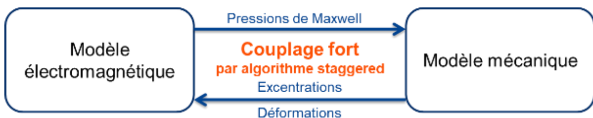
Figure V.2 - Echange d'informations entre les modèles couplés
