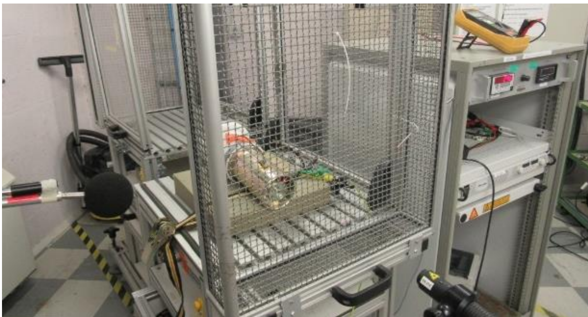
Figure I.6 - Mesure de test de vibration émises sur banc d'essai en salle d'essai réverbérant avec mesure acoustique au rayonné
