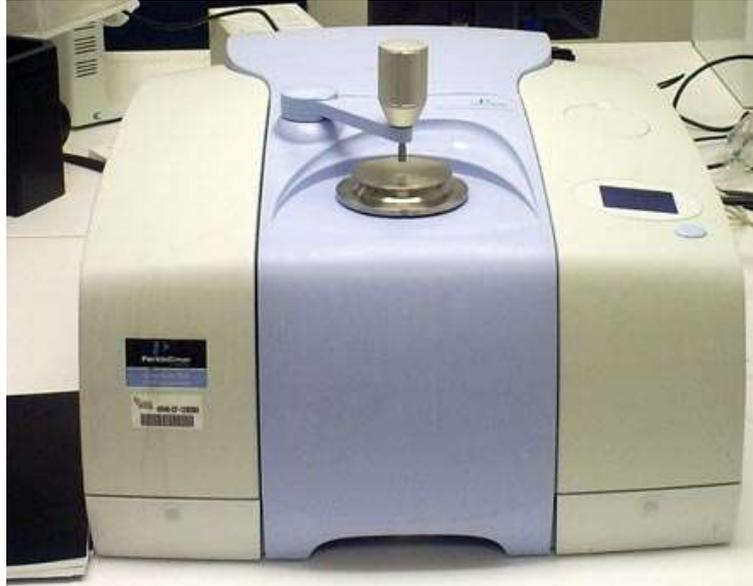
*Figure B. 20 Spectromètre ATR-FTIR utilisé.*
