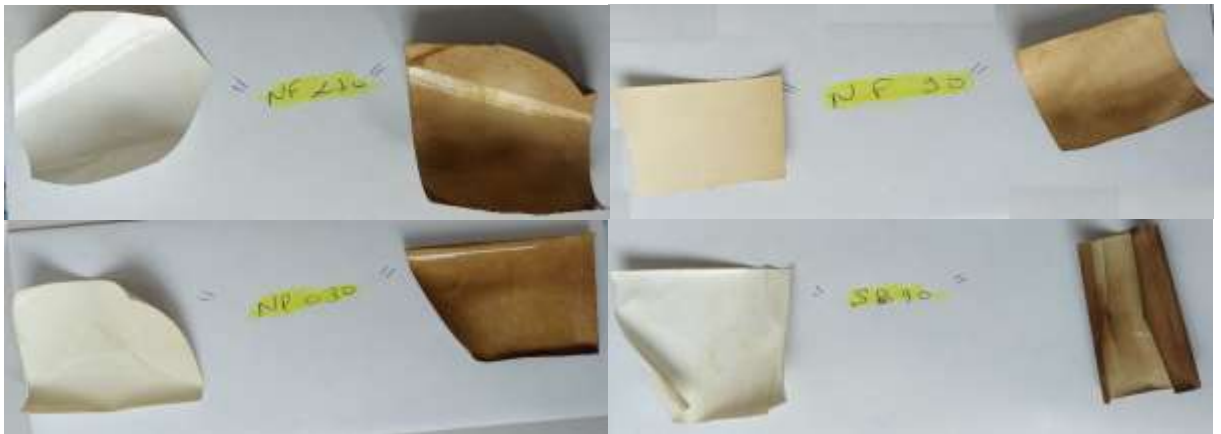
Figure B. 11 Les membranes commerciales de nano-filtration (NF) après modification.
