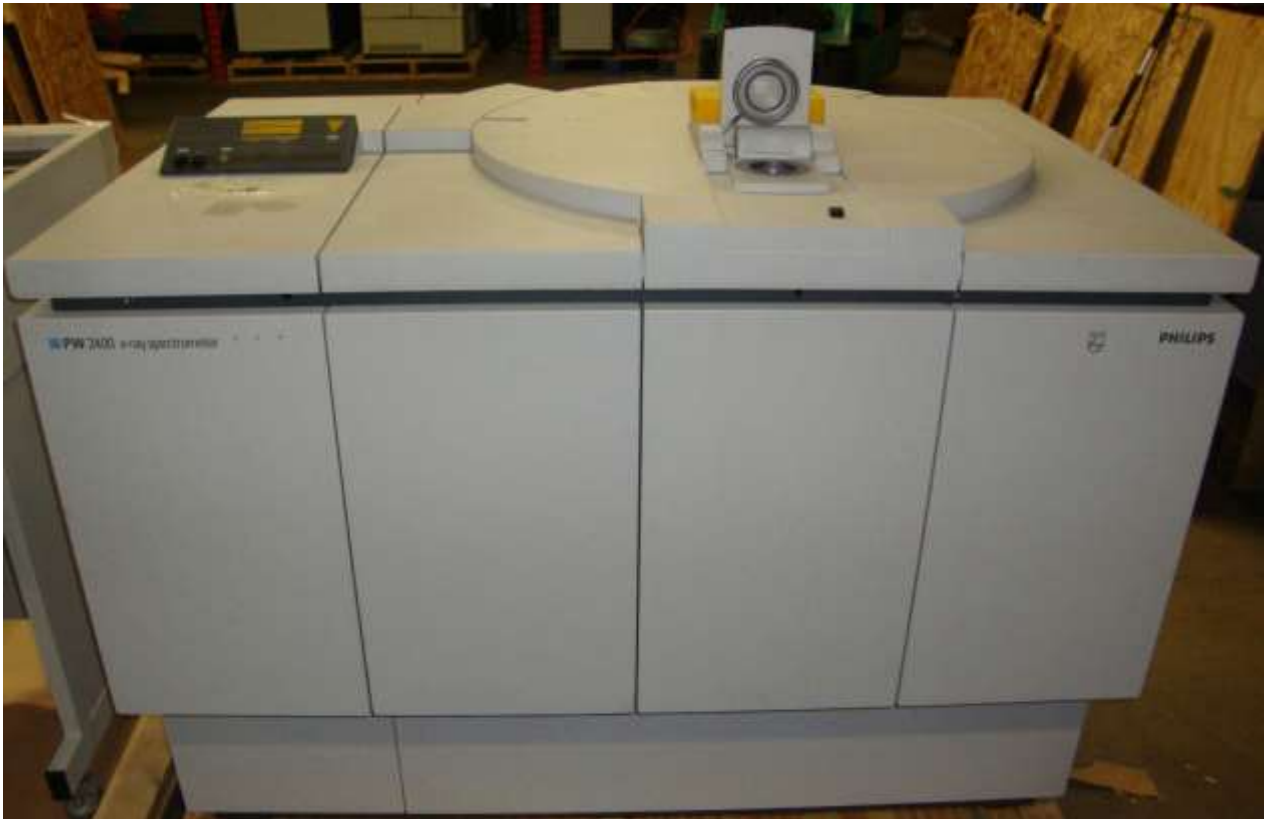
Figure B. 17 Spectromètre de fluorescence X (XRF) utilisé.
