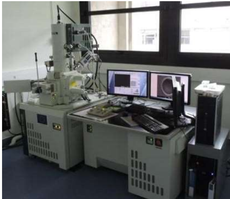
Figure B. 21 Microscope électronique à balayage (MEB).
