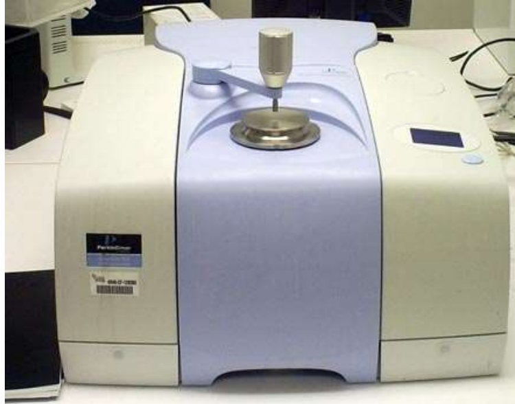
Figure B. 20 Spectromètre ATR-FTIR utilisé.
