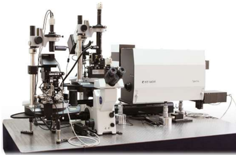
Figure B. 22 Microscope à force atomique (AFM).
