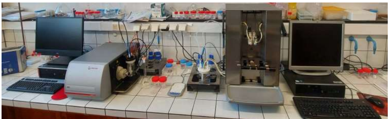
Figure B. 19 Appareillages de mesure du potentiel zéta.
