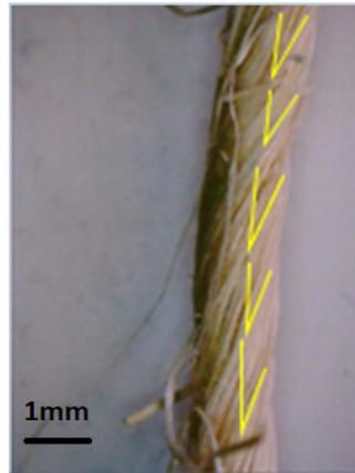
**Figure II.22: Fil de sisal avec la mesure de l'angle de torsion à l'aide du logiciel imageJ [142]**
