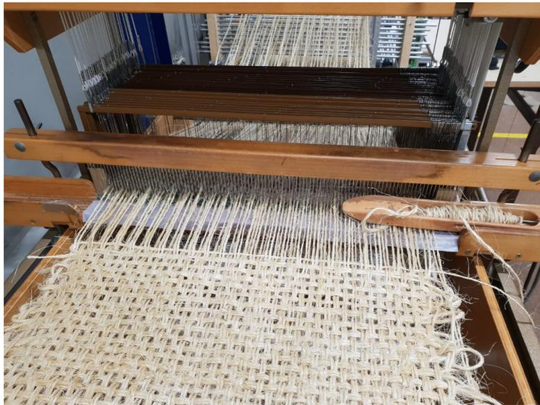
**Figure III.4: Machine à tisser ARM d'échantillonnage**
