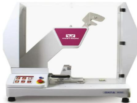
**Figure IV.21: Mouton-pendule motorisé INSTRON CEAST 9050**
