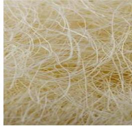
**Figure II.1 : Fibre de sisal**
