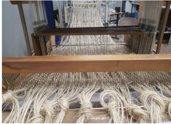
**Figure III.3: Piquage au peigne des fils de chaîne de sisal**
