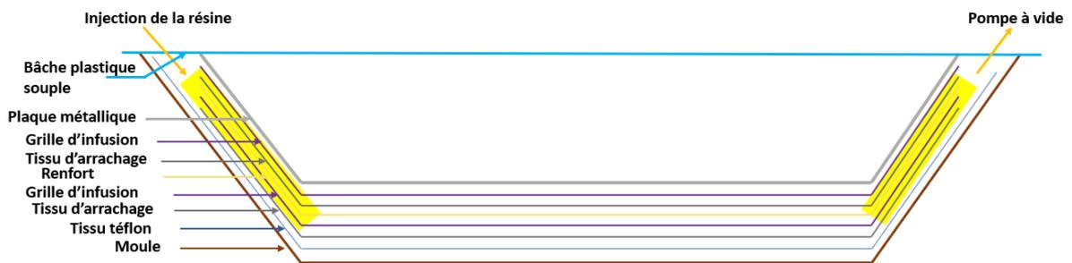
Figure IV.2: Schéma du protocole d'infusion sous vide utilisé
