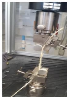
**Figure II.23: Essai en traction du fil de sisal à l'aide du banc de traction MTS SYSTEM**
