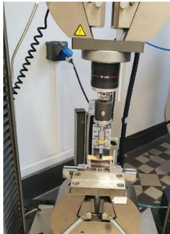
**Figure IV.14: test de l'éprouvette par le banc de flexion INSTRON 5890 2KN**
