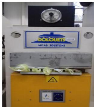
**Figure II.14: Moule IFBT placé dans la presse chauffante**
