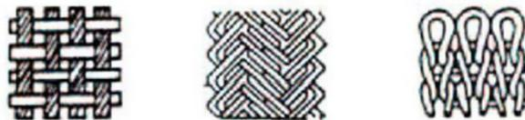
**A. Structure Tissée    B. Structure Tressée    C. Structure Tricotée**
