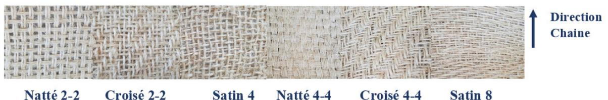
**Figure III.5: Vues d'endroit des structures tissées 2D produites**
