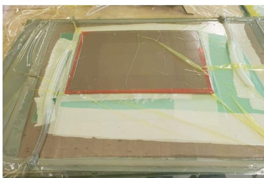
**Figure IV.25: Montage utilisé du procédé d'infusion sous vide des matériaux composites à base des structures tissées 3D interlocks chaines**
