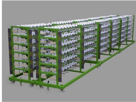
Figure I.30 : Représentation d'un cantre de bobines de fils de chaîne
