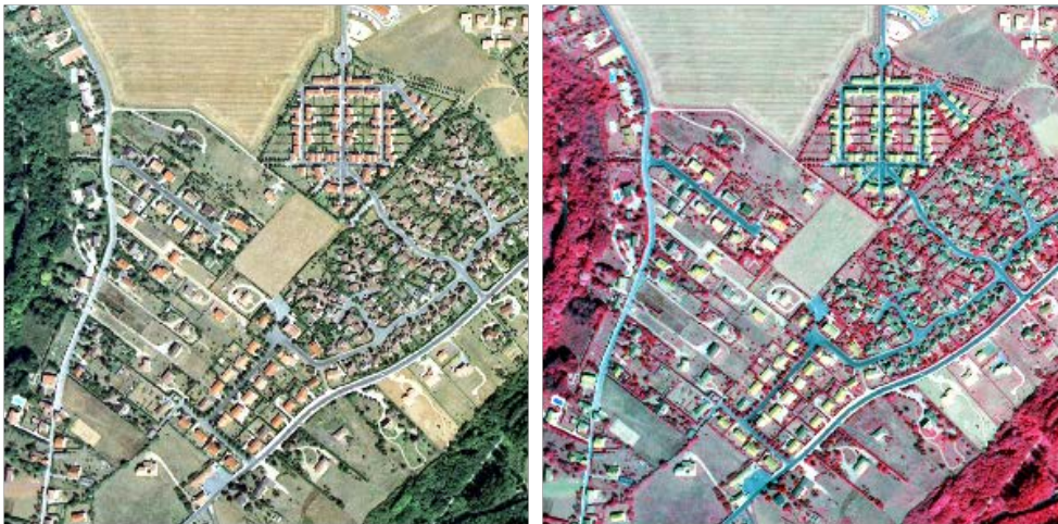
Figure 33 : Orthophotographie obtenue (en vraies couleurs et fausses couleurs) après orthorectification et compilation des dalles brutes de l'IGN (en haut) et zoom sur une zone de l'orthophoto en vraies et fausses couleurs.
