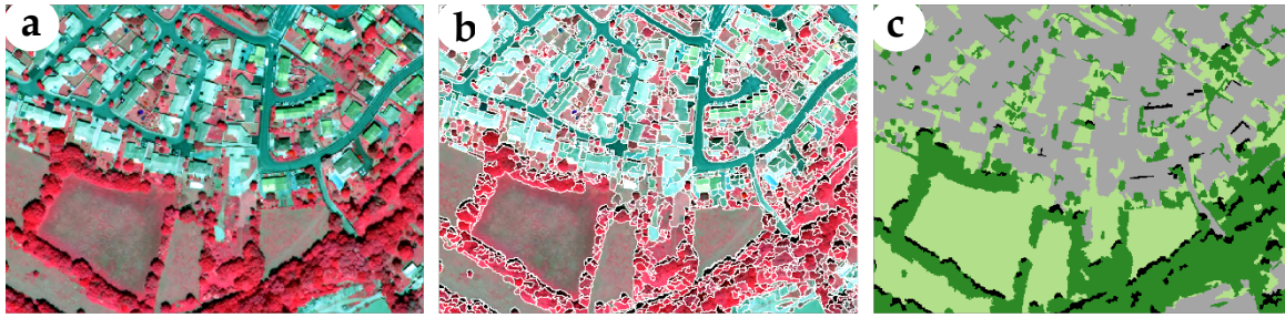
Figure 28 : Résultats des deux principales étapes de la classification orientée-objet : la segmentation créant des objets sémantiques (b) obtenue à partir de l'image IRC (a) et résultat de la classification identifiant les surfaces artificialisées en gris, la végétation herbacée en vert clair et la végétation arborée en vert foncé (c).
