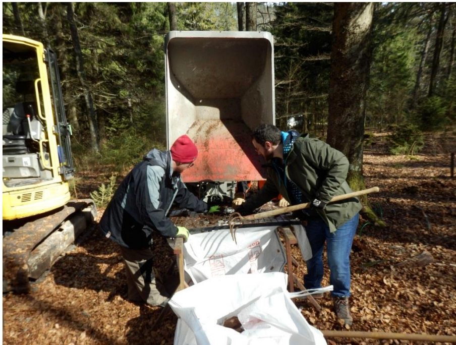
Figure 14: Etape de tamisage à 4 cm à l'aide d'une grille.
