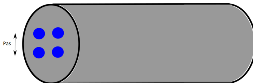
Figure 3.1. Illustration d'une fibre de 4 cœurs
