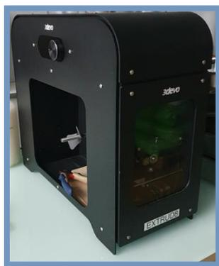
Figure 64: 3devo mini single-screw extruder
