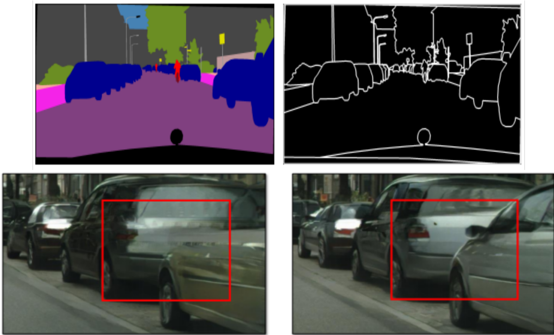
FIGURE 5.3 : Exemple de carte de frontières et impact sur les résultats [WLZ + 18]. Première ligne : carte de labels à gauche et carte de frontières à droite. Deuxième ligne : résultat avec uniquement la carte de labels à gauche, résultat avec les deux cartes à droite.
