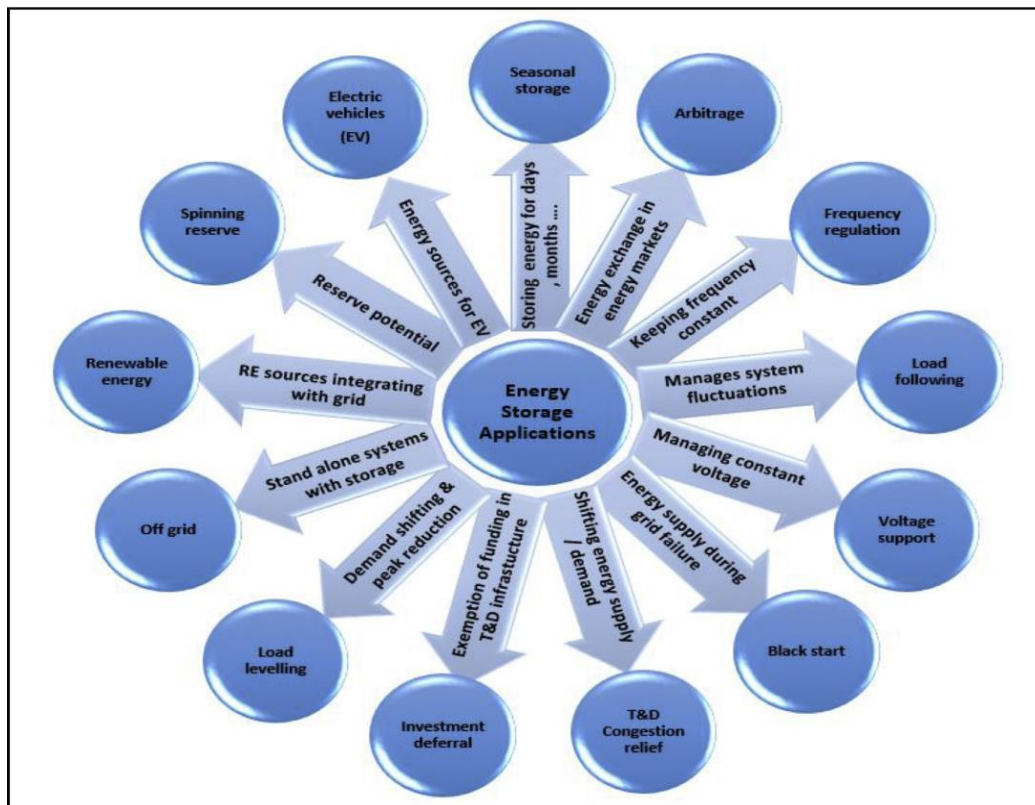
Figure I-18. Applications du stockage d'énergie [47]
