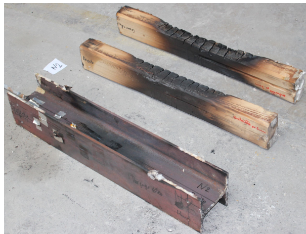
FIGURE III.26 – Essai 1 - éprouvette N2 – bois résiduel après les phases d'exposition au feu puis de refroidissement.
