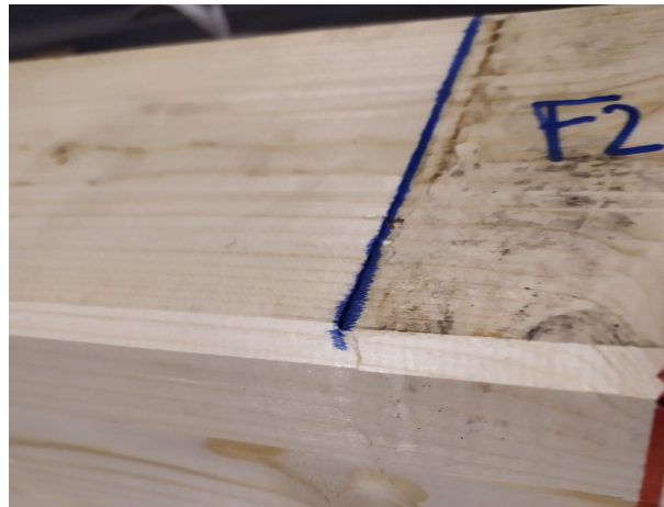
FIGURE II.24 – Enfoncement infime du bois et légère trace de plastification en compression à proximité du point de chargement.
