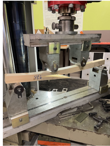
FIGURE VIII – Rupture en flexion observée lors de l'essai n°29 (résistance la plus faible).
