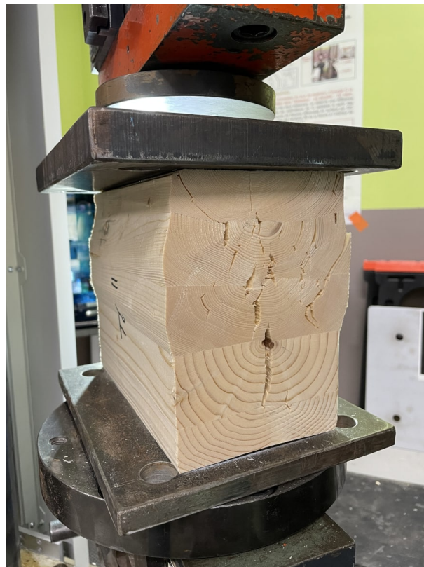
FIGURE II.42 – Rupture d'une éprouvette sollicitée en compression transversale.
