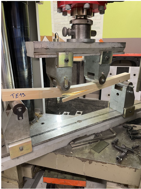
FIGURE VII – Rupture en flexion observée lors de l'essai n°24 (résistance la plus élevée).
