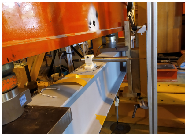
FIGURE II.34 – Poutre A - mesure du déplacement horizontal à mi-travée.
