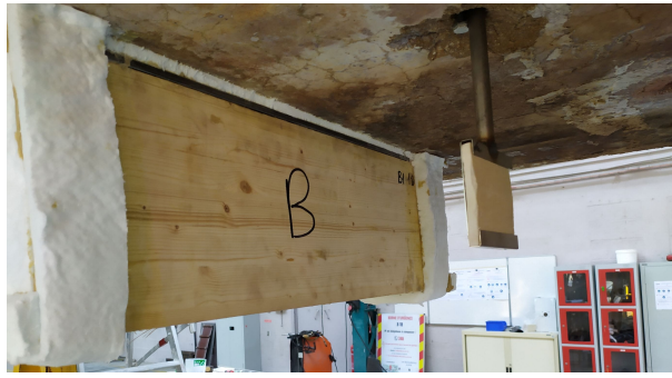
FIGURE III.4 – Essai 2 – pyromètre à plaque employé pour établir la température de l’environnement des éprouvettes B et C.
