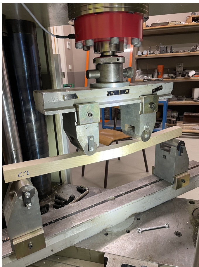
FIGURE IV – Dispositif d'essais pour la caractérisation du bois en flexion.
