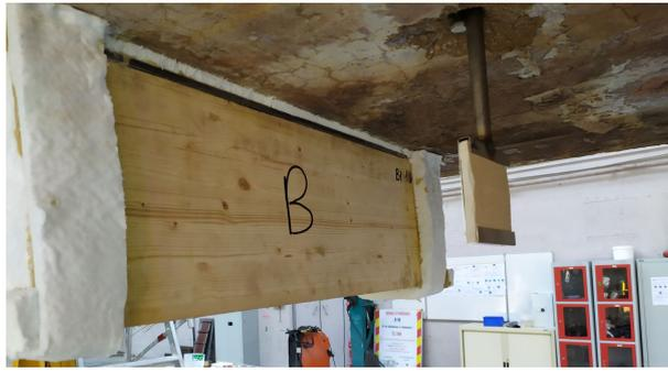
FIGURE III.4 – Essai 2 – pyromètre à plaque employé pour établir la température de l’environnement des éprouvettes B et C.
