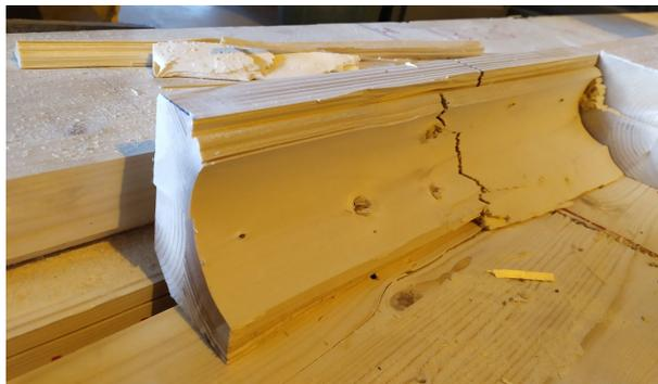
FIGURE II.22 – Poutre B<sub>2.3</sub> - mise en évidence après le sciage d'une rupture le long d'un cerne de croissance vraisemblablement provoquée par le cisaillement longitudinal.
