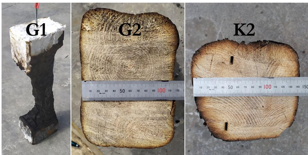
FIGURE III.13 – Essais 1 et 2 - restes des poutres constituées uniquement de bois.
