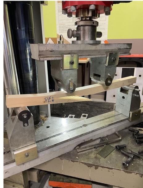
FIGURE VIII – Rupture en flexion observée lors de l'essai n°29 (résistance la plus faible).
