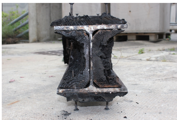
FIGURE III.22 – Essai 1 - éprouvette M2 – bois résiduel après les phases d'exposition au feu puis de refroidissement.
