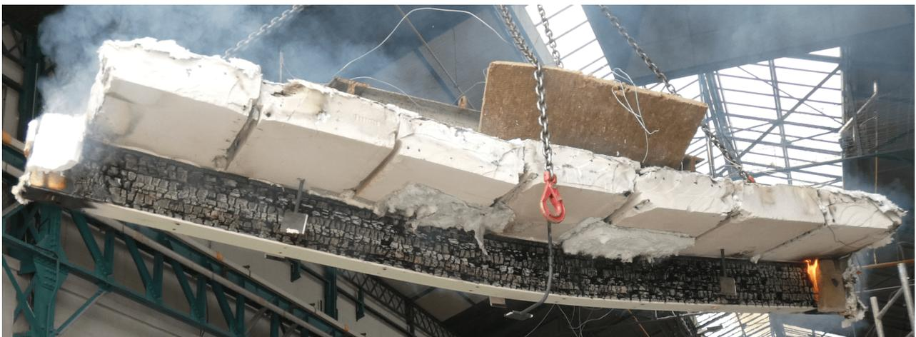
FIGURE IV.37 – Déformée de la poutre AB<sub>I</sub> à l'issue de l'essai CSTB n°3.
