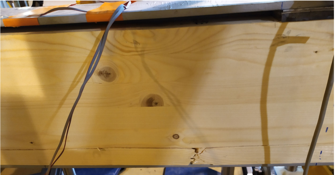
FIGURE II.25 – Poutre ABI.1 - rupture en traction parallèle au fil.
