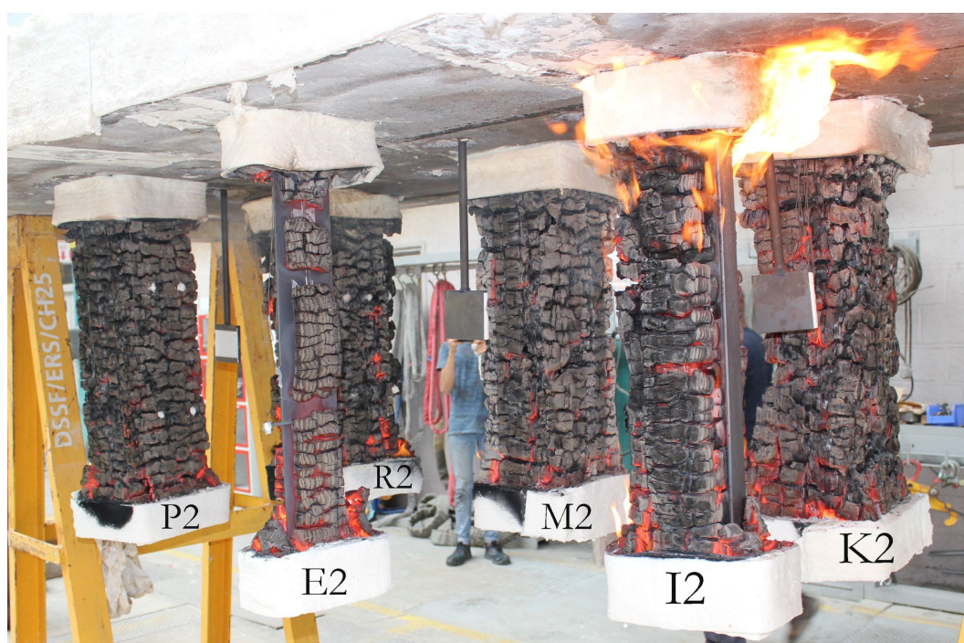
FIGURE III.34 – Essai 2 - poursuite de combustion avec flamme de l'éprouvette I2 juste après la fin de l'exposition au feu.
