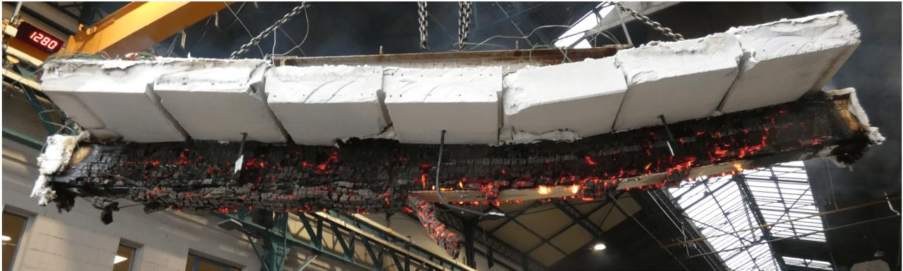
FIGURE IV.36 – Déformée de la poutre AB<sub>2</sub> à l'issue de l'essai CSTB n°4 (appui n°1 situé à gauche, appui n°2 situé à droite).
