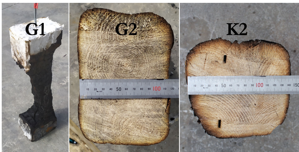
FIGURE III.13 – Essais 1 et 2 - restes des poutres constituées uniquement de bois.
