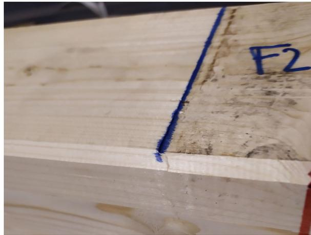
FIGURE II.24 – Enfoncement infime du bois et légère trace de plastification en compression à proximité du point de chargement.
