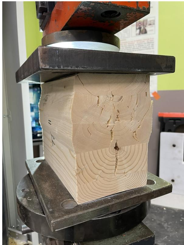
FIGURE II.42 – Rupture d'une éprouvette sollicitée en compression transversale.
