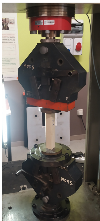
FIGURE 1 – Dispositif d'essai pour la caractérisation du bois en compression longitudinale.
