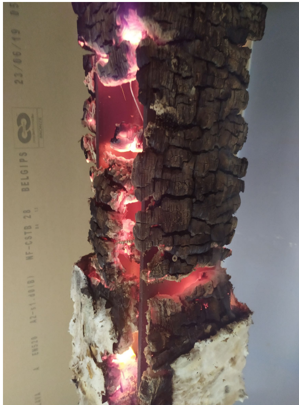
FIGURE III.24 – Essai 1 - éprouvette O2 - la combustion du bois résiduel porte l'acier au rouge pendant la phase de refroidissement.
