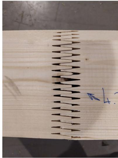
FIGURE II.16 – Poutre B2.2 aboutage défectueux (avant l'essai).
