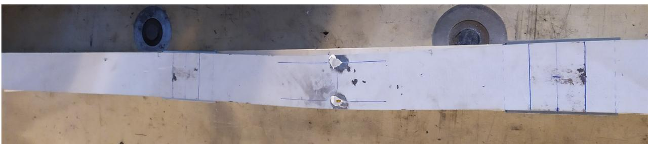
FIGURE II.33 – Poutre AB1.1 - déversement du profilé métallique.
