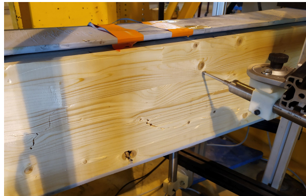
FIGURE II.35 – Poutre ABI.1 - mesure du déplacement horizontal à mi-travée.
