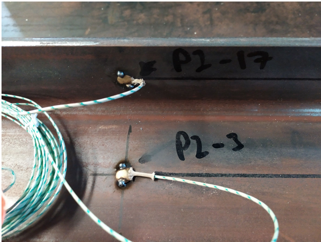
FIGURE III.IO – Essai 2 - éprouvette P2 - thermocouples « pastille » n°3 et 17 utilisés pour la mesure de la température de l'acier.
