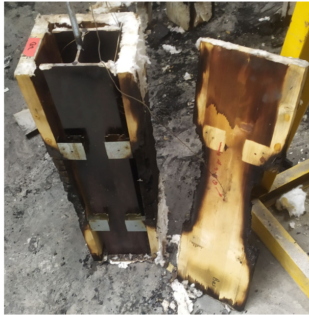
FIGURE III.25 – Essai 1 - éprouvette Q2 – bois résiduel après les phases d'exposition au feu puis de refroidissement.
