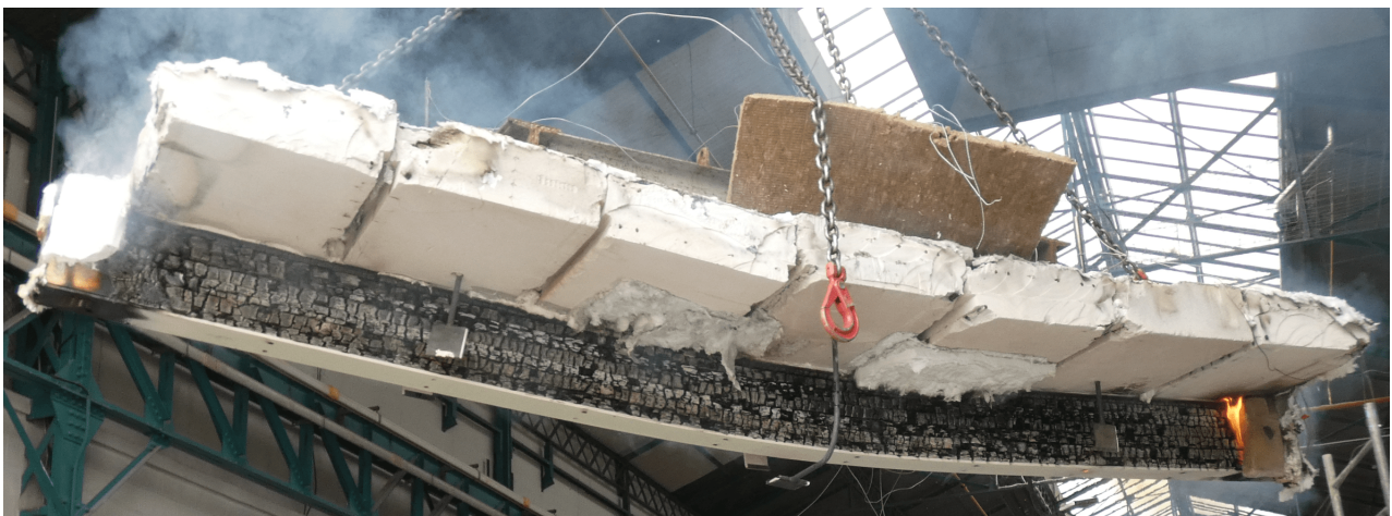
FIGURE IV.37 – Déformée de la poutre AB I à l'issue de l'essai CSTB n°3.
