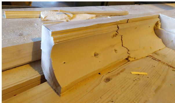
FIGURE II.22 – Poutre B 2.3 - mise en évidence après le sciage d'une rupture le long d'un cerne de croissance vraisemblablement provoquée par le cisaillement longitudinal.
