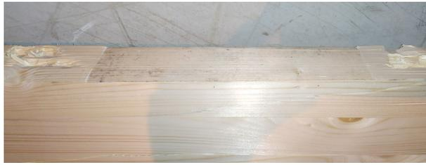
FIGURE II.31 – Poutre AB1.1 - enfoncement du bois au droit de la plaque transférant les charges de la semelle supérieure du profilé vers le bois.
