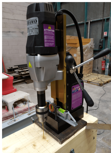
FIGURE IV.1 – Essais n°3 et 4 - Perceuse employée pour réaliser les forages nécessaires à l'instrumentation TC|| des composants en bois.
