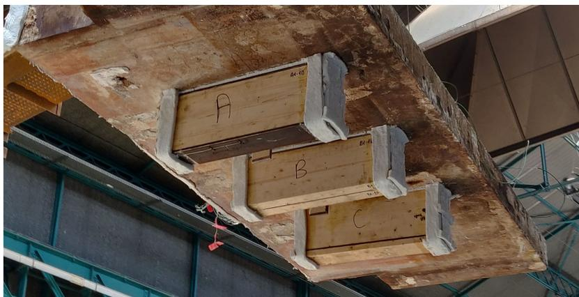
FIGURE III.36 – Essai 2 - dalle 3 avant l'exposition au feu.
