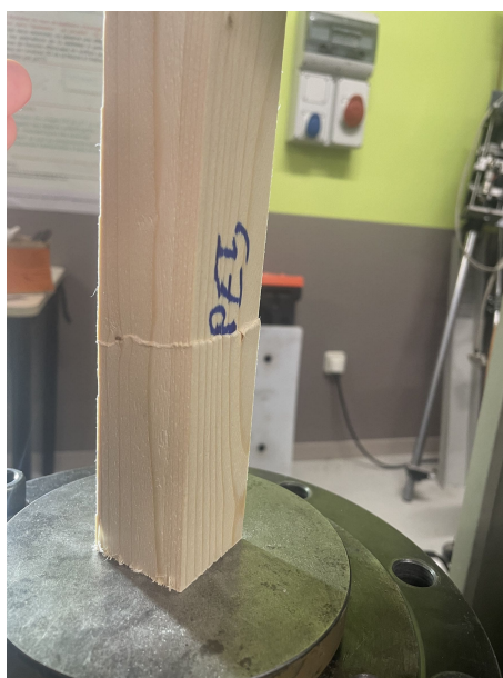
FIGURE III – Ruine d'une éprouvette en compression longitudinale (flambage local des fibres).
