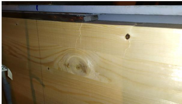
FIGURE II.29 – Poutre AB1.2 - plastification du bois en zone comprimée à proximité du point d'application des charges.
