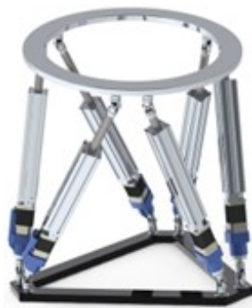
FIGURE 1.8 – La plateforme de Gough-Stewart.
