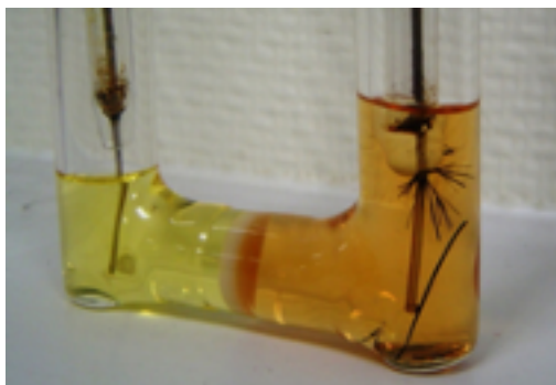
FIGURE 4.10 – Photographie du dispositif d'électrocristallisation pour la croissance de monocristaux © C.Mezière.
