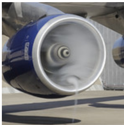
FIGURE I.7 – Ingestion de vortex sur le moteur Rolls-Royce RB211-524G ( Peter Thomas Octobre 2005)
