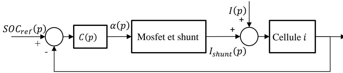
Figure 3.40 Boucle de régulation de SOC pour la cellule de rang i
