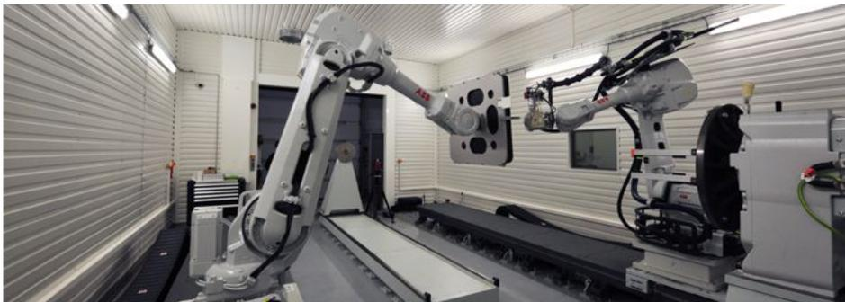
FIGURE 2.8 – La plateforme CND par tomographie rayons X robotisée. (Source : CEA.)
