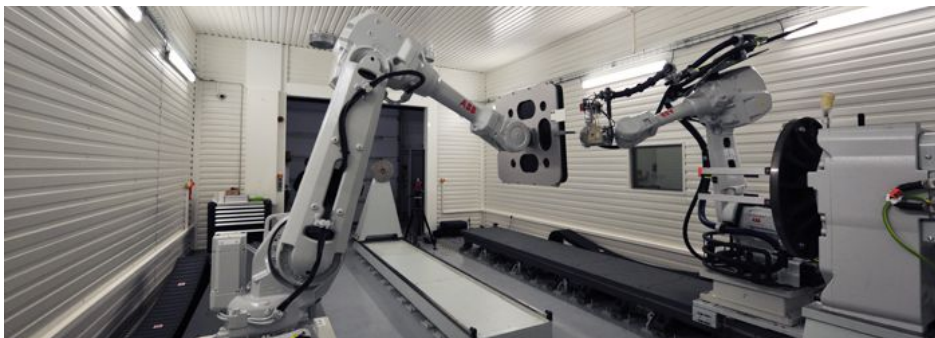
FIGURE 2.8 – La plateforme CND par tomographie rayons X robotisée. (Source : CEA.)
