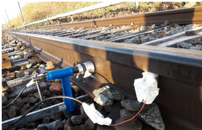
FIGURE 2.4 – Émetteur inspectant des voies ferrées par ondes guidées. (Source : CEA.)
