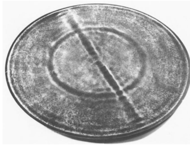
FIGURE 4.2 – Répartition de l'énergie vibratoire dans une plaque circulaire obtenue de manière expérimentale. La plaque est excitée de manière ponctuelle avec un bruit blanc aléatoire avec un mini haut-parleur. On distingue clairement une surintensité sur le diamètre et le cercle passant par le point d'excitation. Figure tirée de [3]
