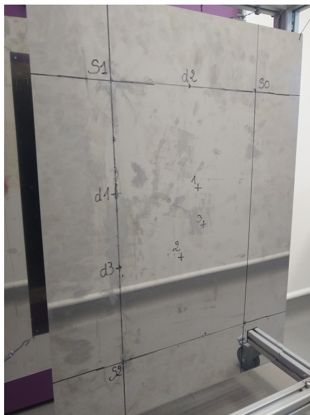
FIGURE 7.5 – Photographie de la plaque 1 avec les différents points de mesure et de couplage ainsi que le point d'excitation ( s_0 ) et les lignes de surintensité.
