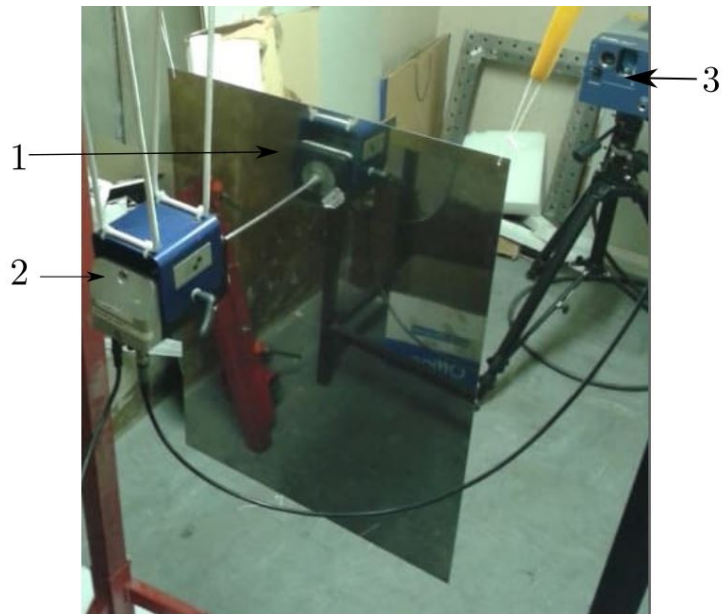
FIGURE 5.2 – Photographie du montage expérimental. La plaque (1) avec les bords libres est suspendue au cadre rigide et est excitée par le pot vibrant (2) et le champ vibratoire est mesuré avec le vibromètre laser (3).
