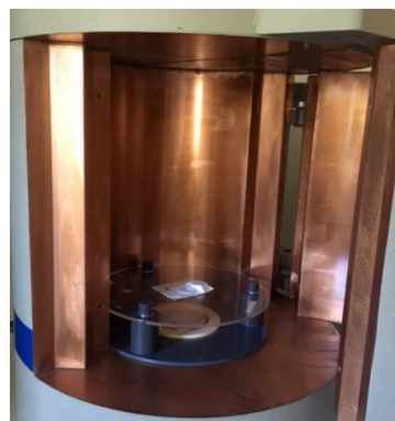
FIGURE 2.10 – Configuration de détection dans le dispositif à bas bruit de fond pour les pastilles SNAC en 2019.
