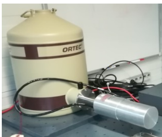
FIGURE 3.9 – Détecteur ORTEC GMX50-83-1-PL et son réservoir d'azote liquide.
