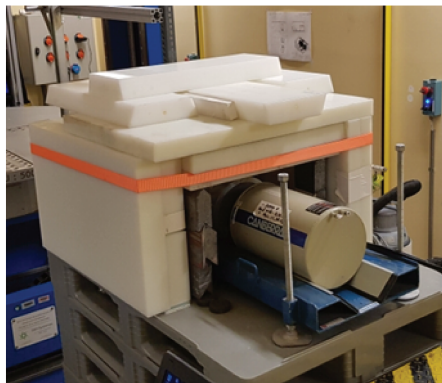
FIGURE 3.5 – Détecteur germanium GR3018 et son blindage neutronique.
