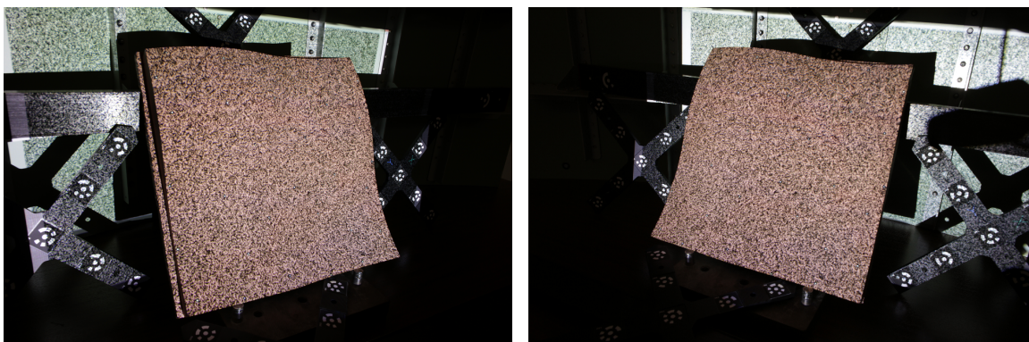
FIGURE 3.1 – Images gauche et droite retenues pour illustrer les problèmes de conditionnement de l'étalonnage explicite
