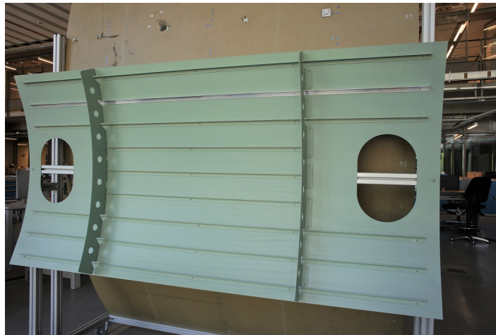
FIGURE 1.11 – Portion de panneau dont le défaut de forme doit être identifié.
