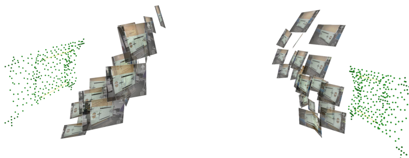
FIGURE 5.5 – Disposition des 29 prises de vue TRITOP par rapport au panneau.
