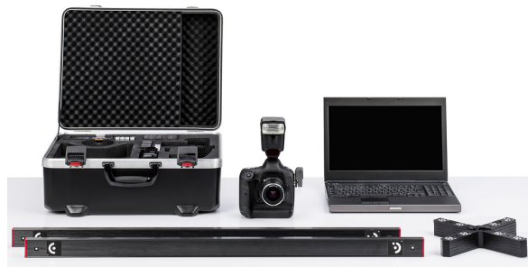
FIGURE 27 – Système de photogrammétrie TRITOP comprenant barres d'étalonnage, croix avec cibles codées et appareil photographique
