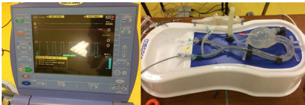
Figure 46 : (A gauche) Console de monitoring de la CPIA permettant de générer une pulsativité à fréquence réglable. (A droite) Modèle vasculaire de cœur battant permettant de générer une pulsativité et de nombreux sites de mesures des pressions et du débit.
