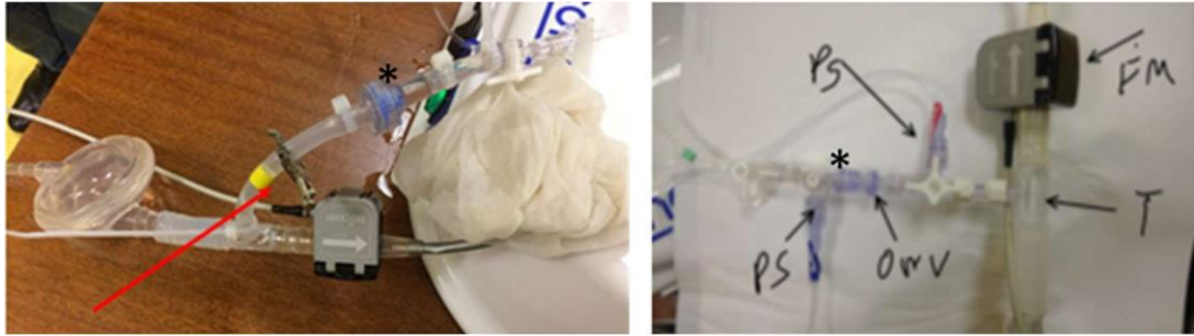
Figure 47 : Descriptif du circuit de simulation intégrant le cœur-battant, le Solopath® et l'IVAC2L®. Ventricule externe (1) et cathéter bidirectionnel (2) du système IVAC2L. Mise en place d'un connecteur (T) entre les deux en Y permettant un flux dirigé vers le membre inférieur. Valve anti-reflux (*) positionnée (2 types ici) sur le circuit dirigé vers le membre inférieur. (A droite) Débitmètre (FM). Mesures de pressions (PS).
