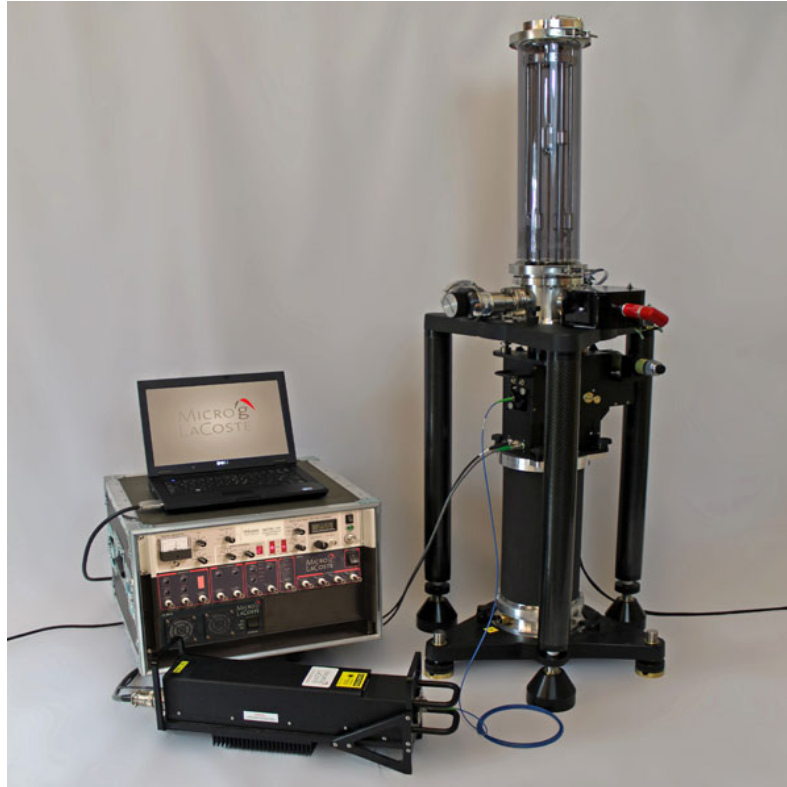
FIGURE 1.2 – Photo du gravimètre à coin de cube FG5-X commercialisé par l’entreprise Micro-g LaCoste. [ https://microglacoste.com/product/fg5-x-absolute-gravimeter/ ]
