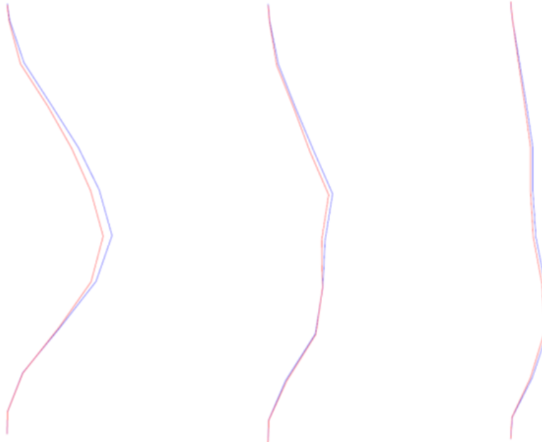
Figure 45 : Déplacements des grilles ROM (rouge) par rapport à la référence (bleu) pour les chargements de forces couplées dans les directions horizontales X et Y. A gauche : forces LAT1/LAT2 – milieu : LAT2/LAT3 – droite : LAT2/LAT5. Déformées x200. Point de vue choisi pour maximiser le déplacement visible.
