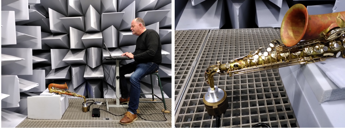
Figure 1.3 – Photos du montage de mesure d'impédance d'un saxophone alto Selmer : le pont d'impédance (Macaluso et Dalmont 2011) est la pièce de bronze connectée au bocal.
