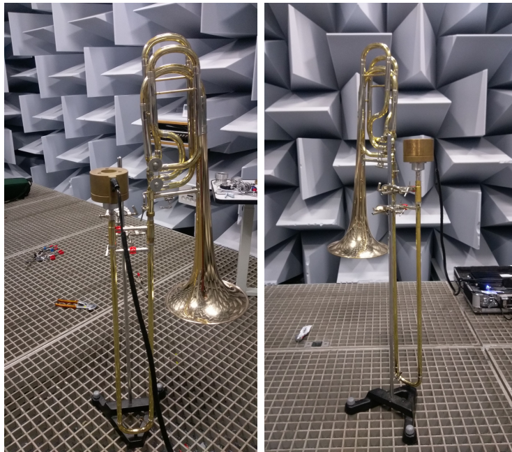
Figure 1.2 – Photos du montage de mesure d'impédance d'un trombone basse Antoine Courtois (modèle AC502) : le pont d'impédance (Macaluso et Dalmont 2011) est la pièce de bronze, connectée à l'embouchure via une pièce d'adaptation en aluminium.
