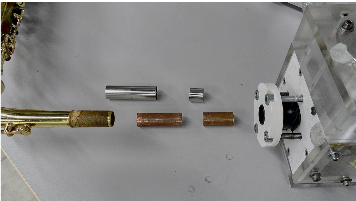
Figure 4.1 – Photo des portions de tubes (en cuivre, longueurs L = 35 mm et L = 50 mm) qu'il est possible d'insérer entre le bocal et le bec du saxophone. Le diamètre intérieur des tubes est identique au diamètre intérieur d'entrée du bocal. Les tubes sont maintenus ensemble par des manchons en inox, visibles au-dessus.
