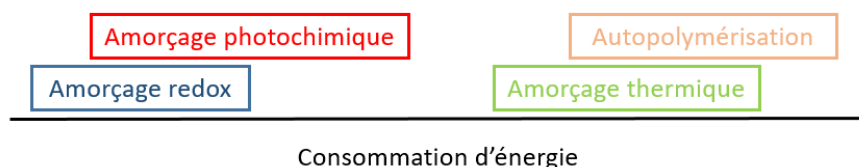
Schéma 2: Consommation en énergie (qualitative) d'une réaction de polymérisation selon la voie d'amorçage choisie
