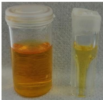
Figure 6: Photos du VS63 dans de l'ACN avant (à droite) et après (à gauche) irradiation à 395 nm, 8 W/cm 2 , température ambiante
