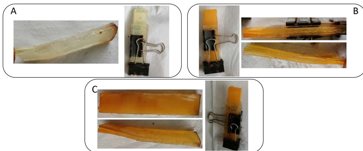
Figure 16: Photos des échantillons après avoir été immergés dans de l'eau pendant environ 24 h. (A) 10 %wt. Ctrl Upy, 0, 5 %wt. BAPO dans du HEMA ; (B) (C) 10 %wt. Bbox, 0, 5 %wt. BAPO dans du HEMA
