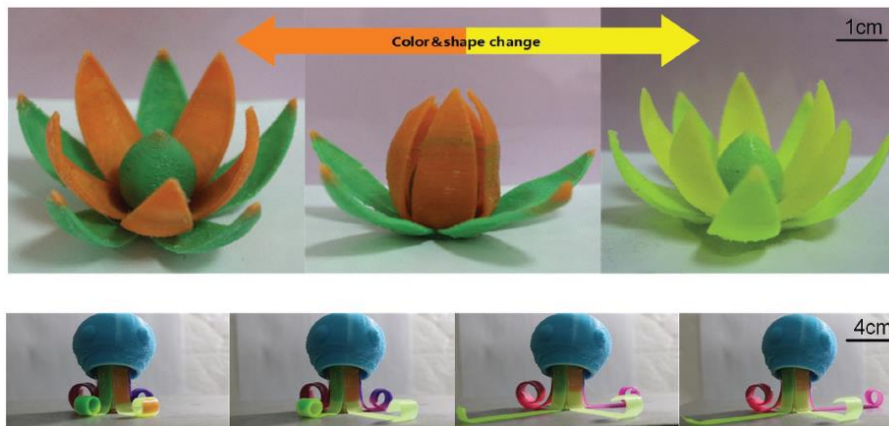
Figure 5: Exemple d'objets multi-matériaux répondant à l'augmentation de la température (au-delà de leur température d'activation) par un déploiement et un changement de couleur 65
