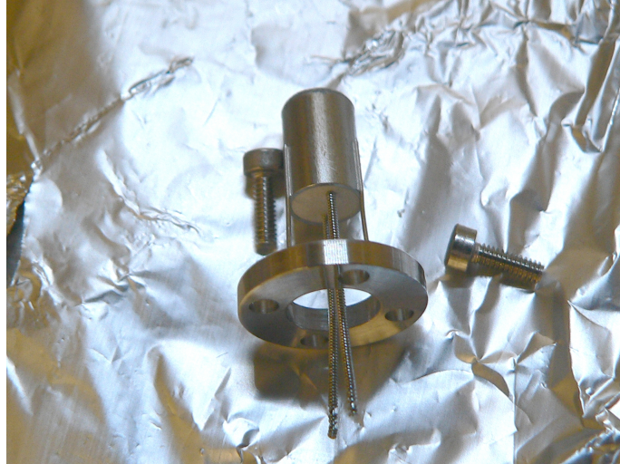
Figure 3.11 – Source thermoionique; le cylindre de poudre solide, de longueur 9.9 mm et diamètre 6.35 mm, est entouré d'une plaque métallique fixée à l'aide de trois tiges à une bague percée de quatre trous, permettant ainsi de fixer la source à l'aide de vis sur un support approprié; le filament traverse le cylindre de poudre, ses deux extrémités sortant du même côté et passant au centre de la bague.
