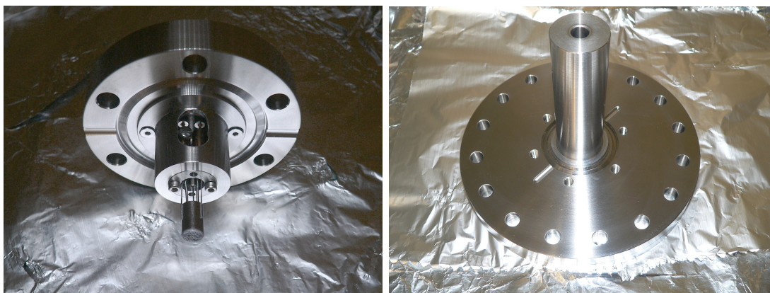
Figure 3.16 – Source thermoionique fixée à la bride supérieure (gauche), électrode d’extraction sur la bride d’adaptation modifiée (droite).
