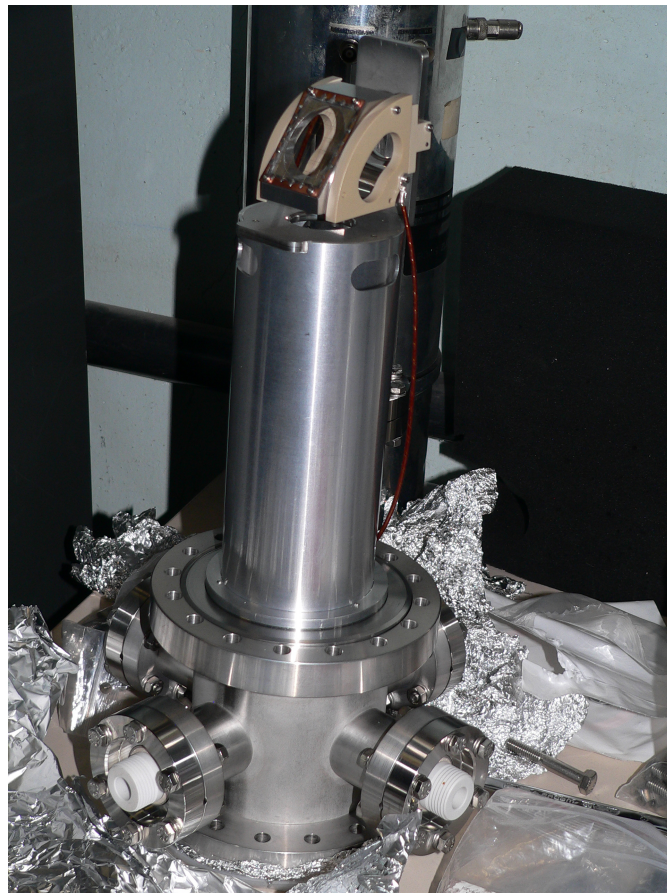
Figure 3.18 – Deflecteur fixé à la chambre à vide par l'intermédiaire du tube, permettant aussi son alignement avec le reste des éléments de la source d'ions.
