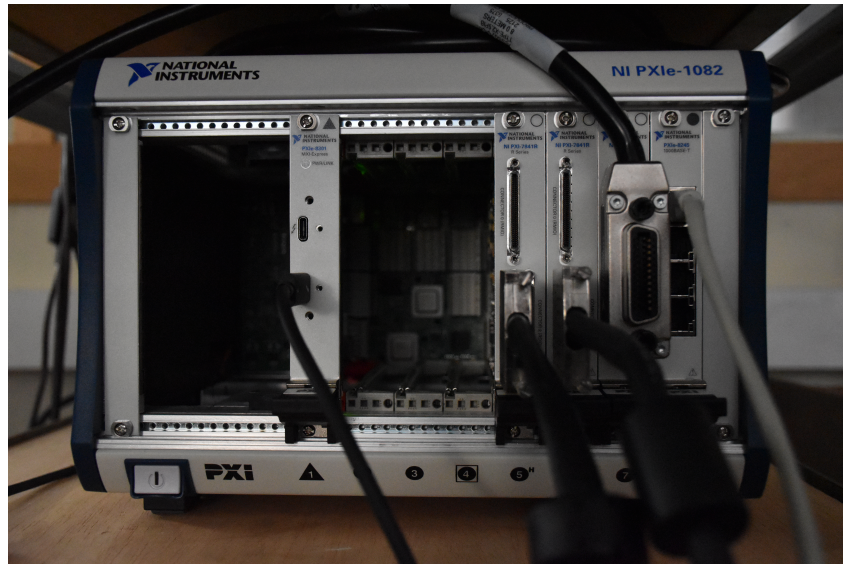
Figure 3.35 – Chassis PXI contenant une carte Thunderbolt, deux cartes FPGA, une carte GPIB et une carte ethernet pour le contrôle et commande des équipements de MLLTRAP.
