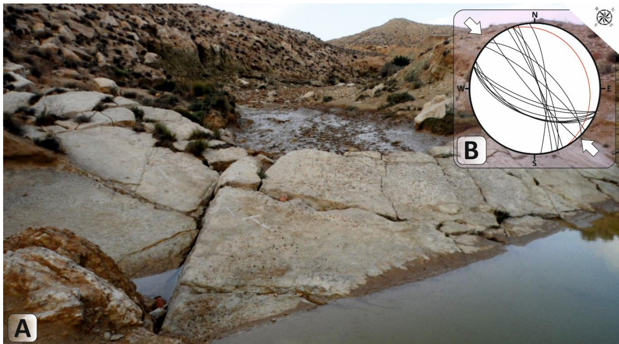
Figure 63 : Photographie, représentations stéréographiques et interprétations des fractures mesurées au niveau d'oued Khanguet Aicha. A : photo de plan de fracture et joints. B : Représentation stéréographique des fractures et de la surface S0.
