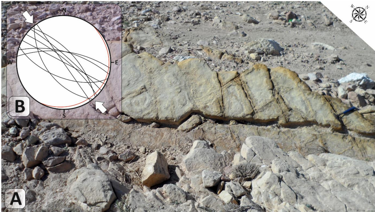
Figure 80: Photographie, représentations stéréographiques et interprétations des fractures mesurées au niveau de Khanguet Amor. (A) Photo de plan d'une fracture et des joints. (B) Représentation stéréographique des fractures et de surface S0.
