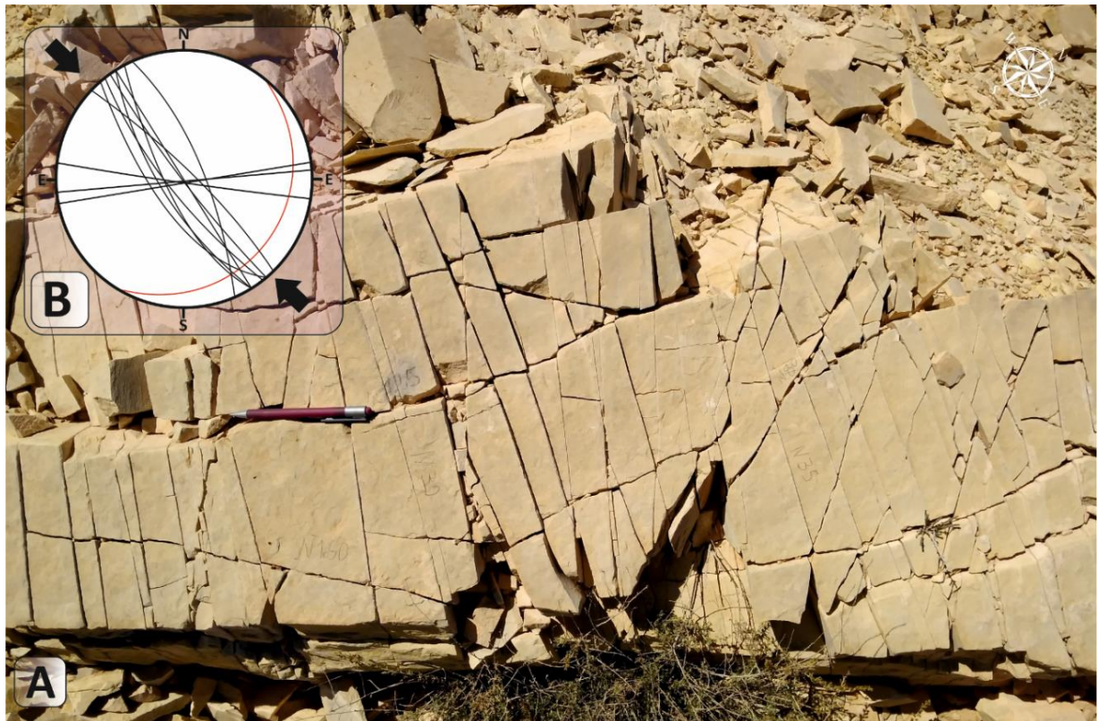
Figure 87: (A) & (B) Photographie et représentation stéréographique des fractures mesurées sur l'affleurement carbonaté de la formation Bouhedma.
