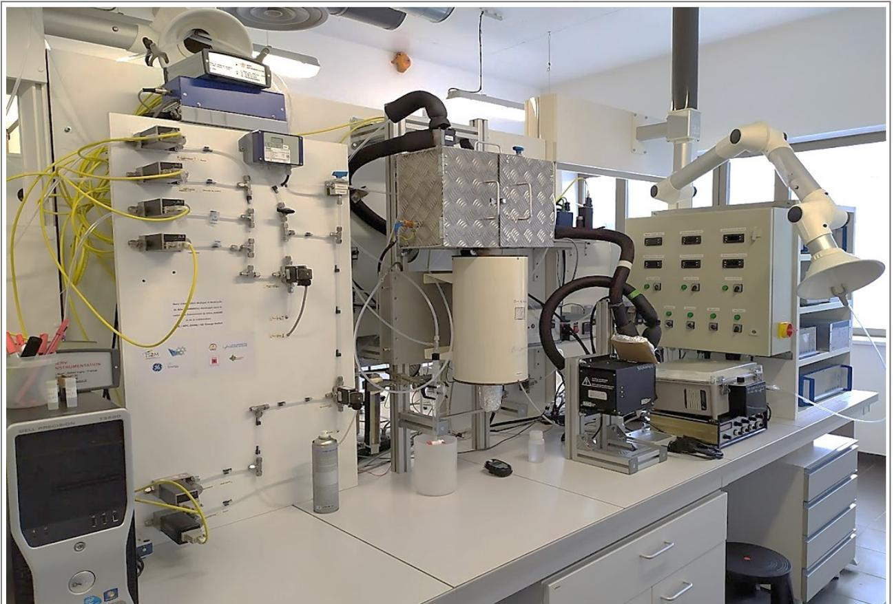
**Figure II-8** Photo du banc d'essai automatisé utilisé pour l'évaluation des performances en désulfuration des adsorbants.
