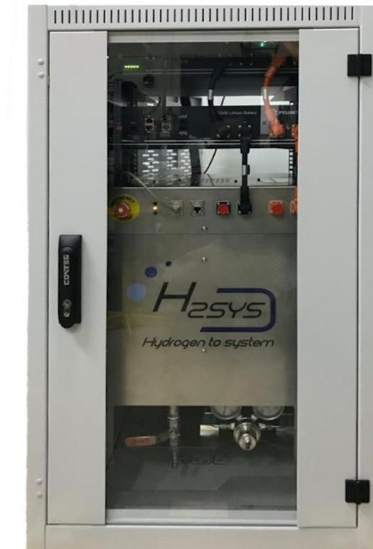
Figure II.25 : Photographie de la pile à combustible PEM du projet RECIF.
