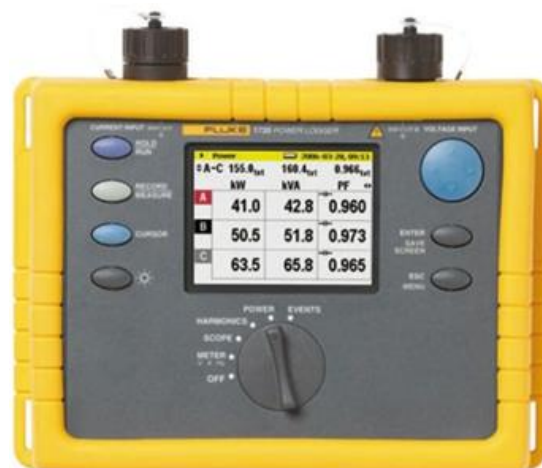
Figure IV.6 : Photographie et caractéristiques techniques de l'analyseur de réseau triphasé Fluke1735 .
