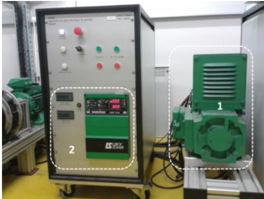
Figure II-9 : Groupe machine asynchrone/machine DC utilisé comme charge.
