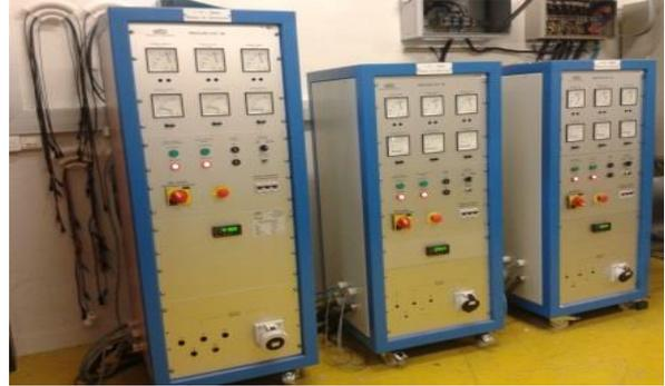
Figure II-12 : Les trois auto transformateurs émulant les postes sources pour les OLTC.
