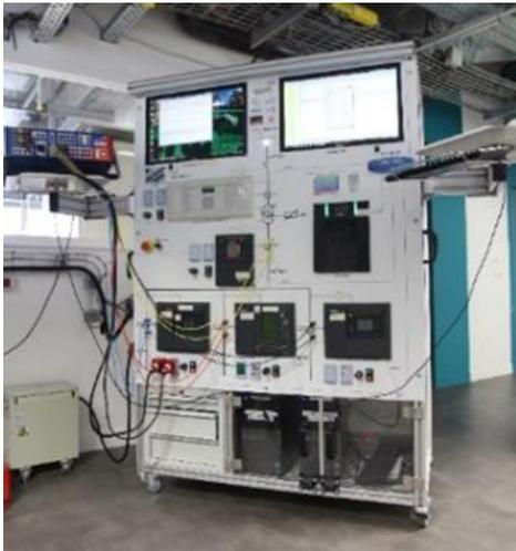
Figure IV-3 : Sous-station intelligente
