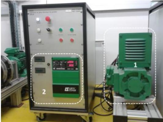
Figure II-9 : Groupe machine asynchrone/machine DC utilisé comme charge.
