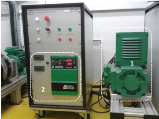
Figure II-9 : Groupe machine asynchrone/machine DC utilisé comme charge.
