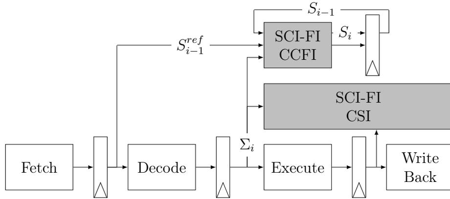
FIGURE 4.2 – Extensions du CV32E40P avec SCI-FI (modules gris)
