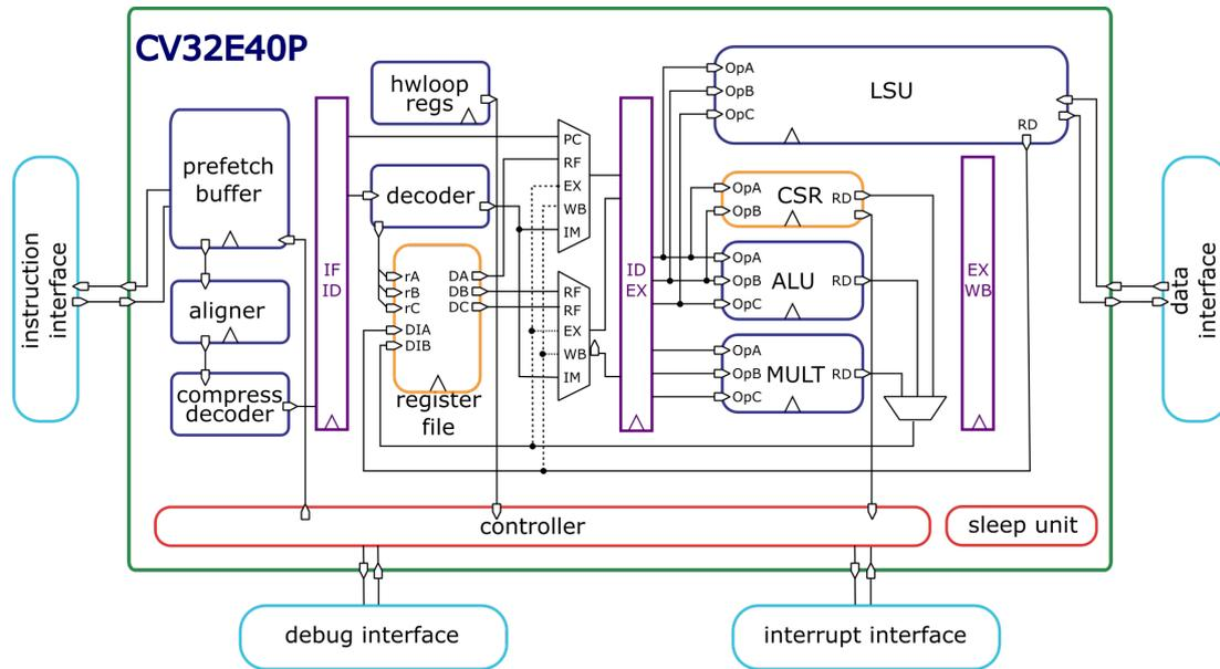
FIGURE 4.1 – Organisation du pipeline du processeur CV32E40P
