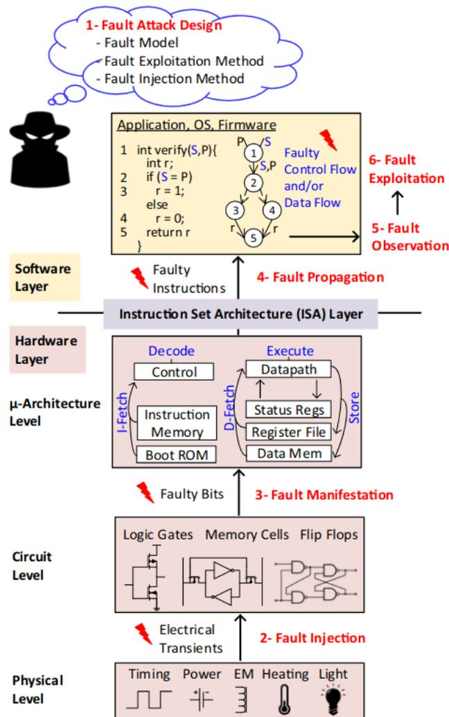
FIGURE 2.1 – Illustration du processus d’injection de faute dans un circuit intégré [YUCE et al. 2018]
