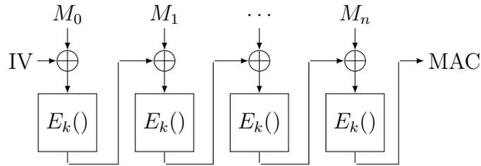
FIGURE 4.3 – Principe de calcul d'un CBC-MAC
