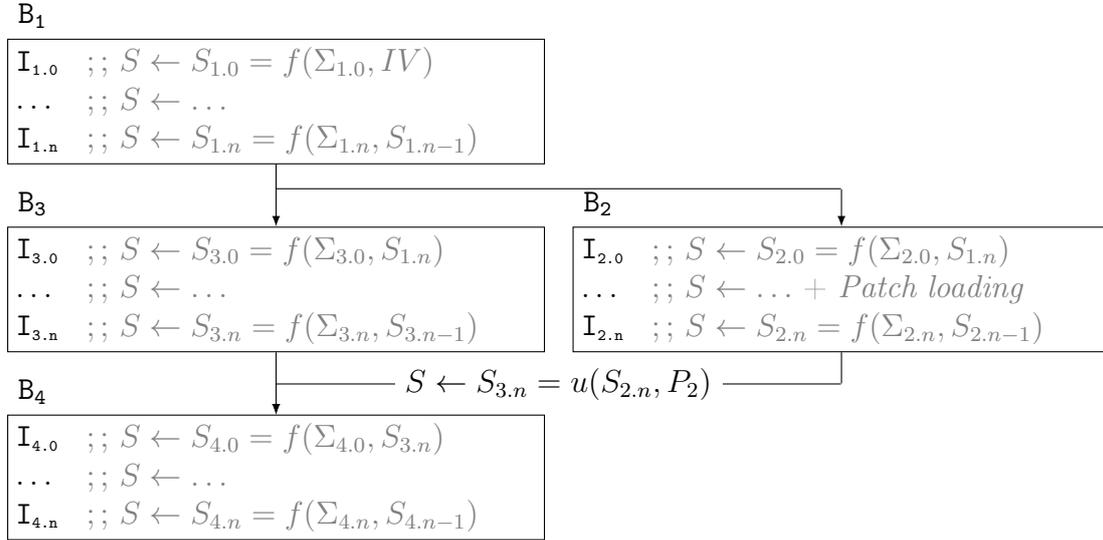
FIGURE 3.2 – Exemple du calcul d'une signature GPSA pour plusieurs blocs de base. Une mise à jour est nécessaire dans le bloc de base B<sub>2</sub> à cause des blocs de base B<sub>2</sub> et B<sub>3</sub> qui se rejoignent.
