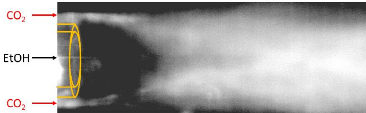
Figure 22 : Image de l'injecteur turbulent coaxial dans un microréacteur par caméra à haute vitesse (Zhang, 2019).
