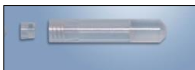
Figure IV-9. Insert Kel-F et son bouchon conique
