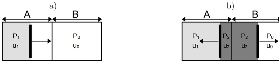
Figure 18 : Passage d'un choc incident 0 \rightarrow 1 à l'interface entre les milieux A et B initialement au repos a) : dans B une onde 0 \rightarrow 2 est transmise, dans A une onde 1 \rightarrow 2 est réfléchi b).
