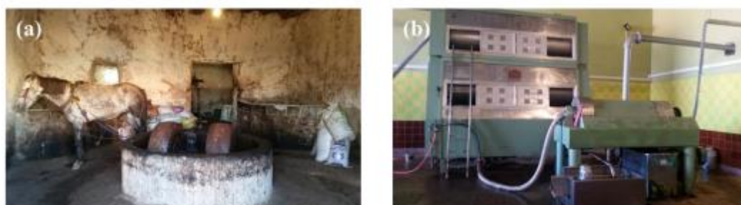
Figure 21 : images (a) d'unité traditionnelle et (b) semi-moderne de trituration des olives
