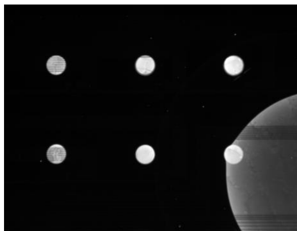
Figure 66. Micrographie d'une autre région de puce de BioFETs fonctionnalisée suivant le protocole EHTES. ssDNA ( 10\ \mu\text{M} ) greffées par microdéposition au robot de dispense de gouttes, tDNA-Cy3 ( 2\ \mu\text{M} ). Le niveau de bruit de fond est quasi nul.
