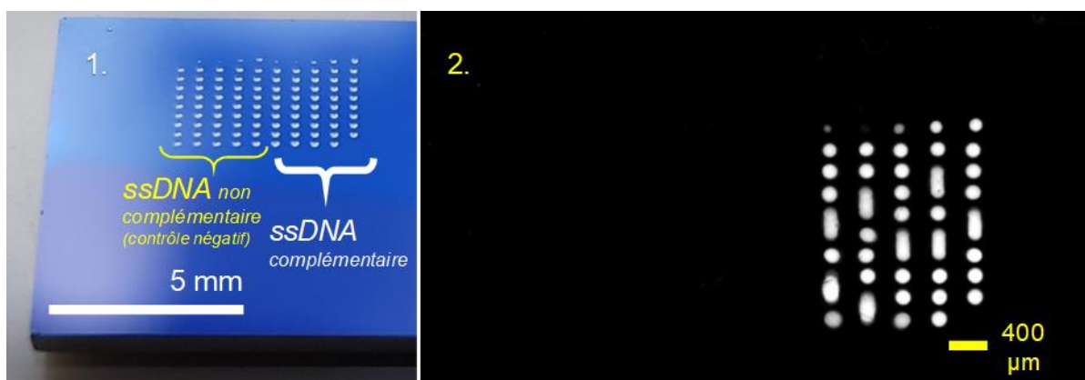
Figure 64. 1. Photographie d'un échantillon de SiO 2 fonctionnalisé suivant le protocole EHTES. Des microgouttes de ssDNA (10 μM) d'environ 300 pL sont déposées à la surface de l'échantillon fonctionnalisé. 2. Micrographie de fluorescence réalisée après l'essai d'hybridation tDNA -Cy3 (2 μM). Le bruit de fond est nul.
