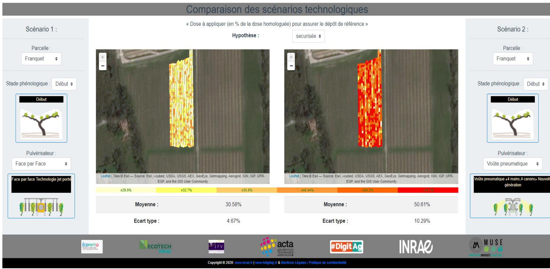
Figure A. 2. Comparaison des doses de produits phytosanitaires à appliquer en fonction des caractéristiques de la végétation et de la performance d'application du pulvérisateur. Exemples de cartes de préconisation obtenues pour deux scénarios technologiques évalués en termes de pourcentage de doses homologuée à appliquer selon l'hypothèse de niveau de protection phytosanitaire « sécurisée ». Scénario 1 (à gauche) : parcelle Franquet, en début de végétation, pulvérisateur face par face. Scénario 2 (à droite) : parcelle Franquet, en début de végétation, pulvérisateur voûte pneumatique. Chaque point représente une unité spatiale (pixel 3 m).
